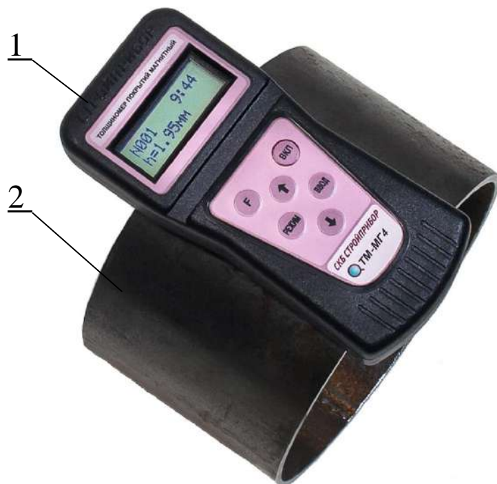
Рисунок 2.1 – Положение толщиномера на изделии при измерении
